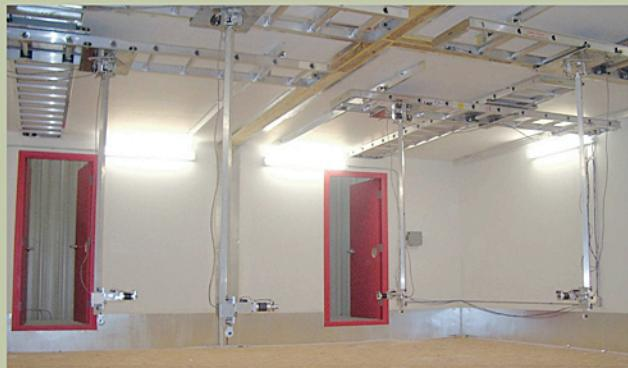
캐나다국립연구소의 세계 최첨단 Flanking Facility 시험설비 내부모습 (총 8개의 방으로 되어 있고 Microphone이 달려있는 Robot이 각방에 설치되어 있고, 컴퓨터에 의해 Robot이 조정됨)
