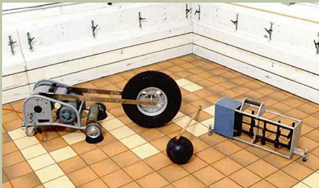
한국에서는 표준충격원의 종류로 중량충격원인 뱅머신을 사용하여 바닥충격음차단구조의 성능을 평가하고 있음 (왼쪽부터, 중량충격원인 Bang Machine 및 Impact Ball, 경량 충격원인 Tapping Machine의 모습)
